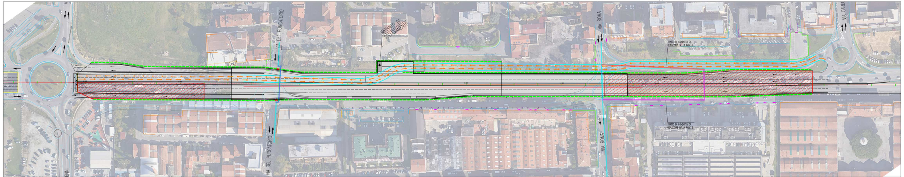
FASE 3b - REALIZZAZIONE TRATTO EST - Apertura della corsia Nord del nuovo Sottopasso fino a via Verona e deviazione Declassata su Complanare. Chiusura di via Roma. Completamento del nuovo Sottopasso in prossimità di via Nenni e tra via Verona e via Marx.
