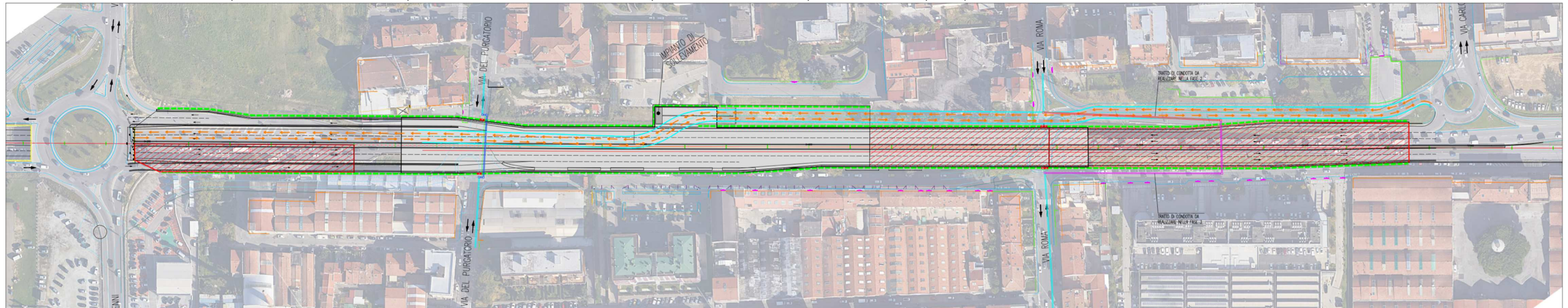
FASE 3b - REALIZZAZIONE TRATTO EST - Apertura della corsia Nord del nuovo Sottopasso fino a via Verona e deviazione Declassata su Complanare. Chiusura di via Roma. Completamento del nuovo Sottopasso in prossimità di via Nenni e tra via Verona e via Marx.
