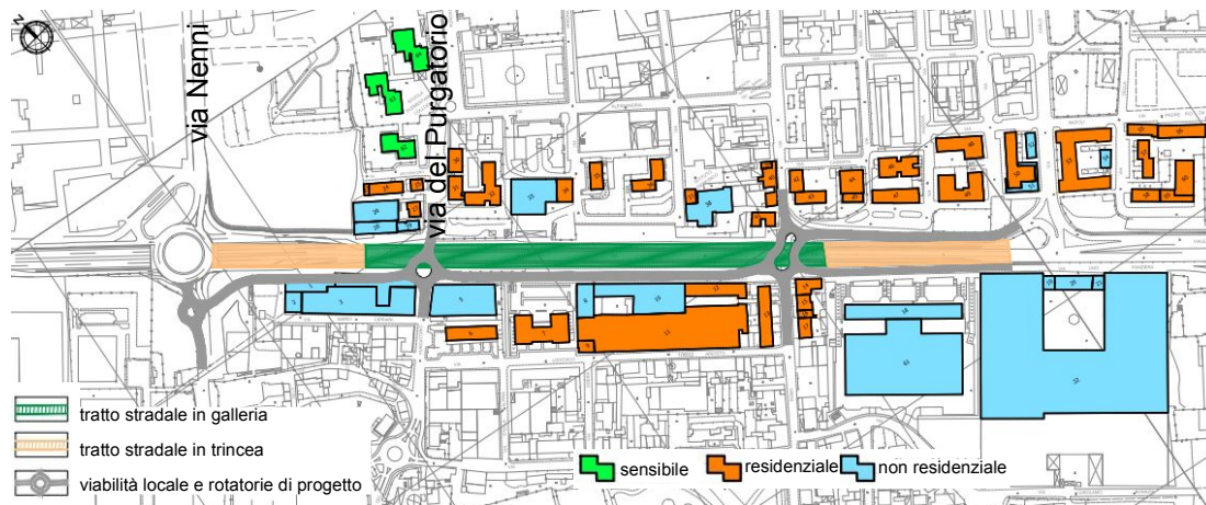
Figura 1. Planimetria dell'intervento con indicati gli edifici ricettori.
