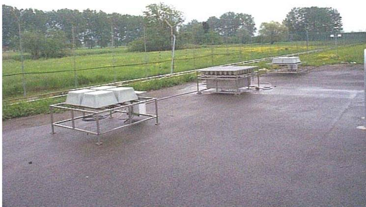
**Fig.4** – Il sistema integrato RASS/SODAR.
